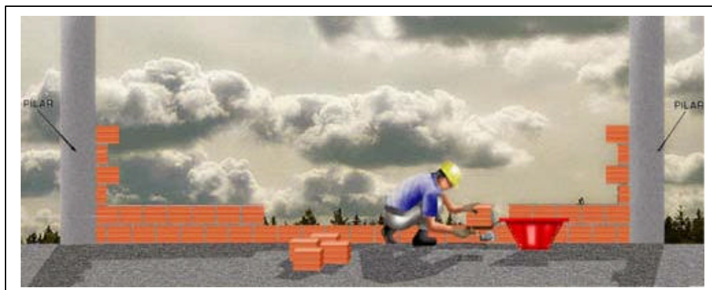
Figura 50. Assentamento de Alvenaria 01
