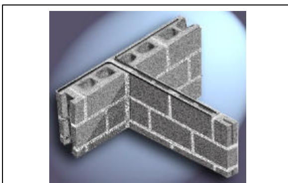
Figura 16. Amarração de Painéis com Armadura
