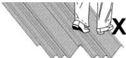
**Figura 115.** As abas das telhas não resistem a cargas concentradas
