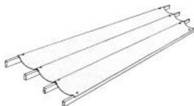
Figura 94. Fixação em longarinas.
