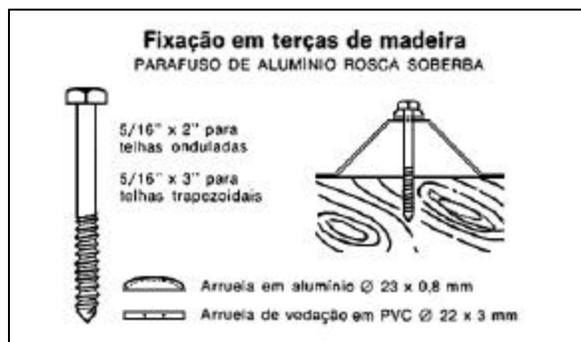
Figura 24. Fixação em terças de madeira
