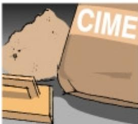
Caso a parede apresente falhas, trincas, traço fraco etc., deve-se preparar a mesma para receber o revestimento, usando massa regularizadora composta de cimento, água e cola PVA suficiente
