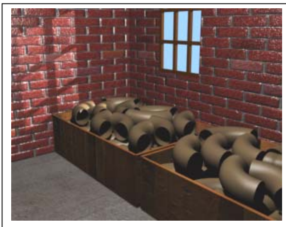
Fig. 04. Armazenagem de conexões em gavetas
