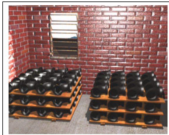
Fig. 04 . Armazenagem das conexões de ferro fundido
