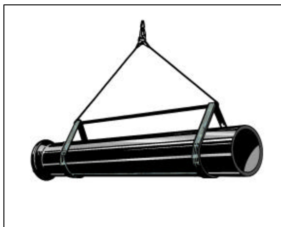
Fig. 02. Movimentação com utilização de cintas e "balancim"
