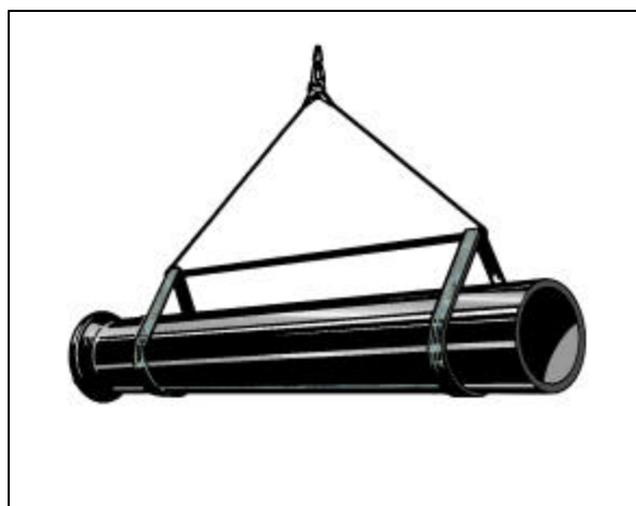
Fig. 02. Movimentação com utilização de cintas e "balancim"
