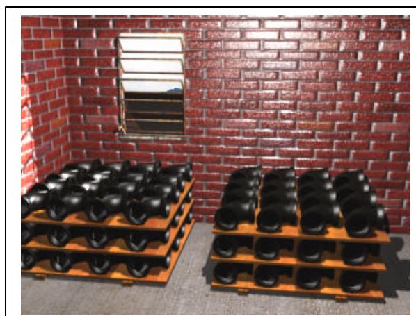
Fig. 06. Armazenagem de conexões em ferro fundido
