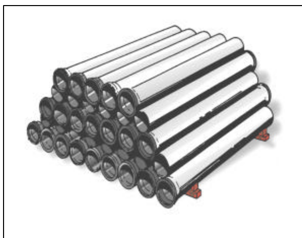
Fig. 03. Armazenagem em leitos superpostos, com bolsas em sentidos alternados
