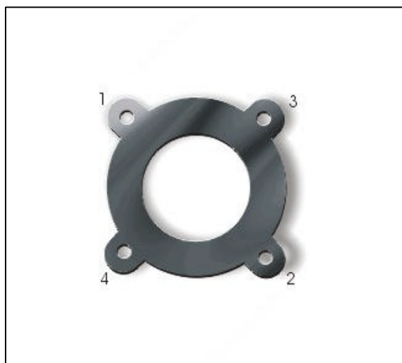
Fig 07. O aperto dos tirantes deverá ser feito de forma alternada, até a obtenção de uma compressão adequada do anel de vedação.
