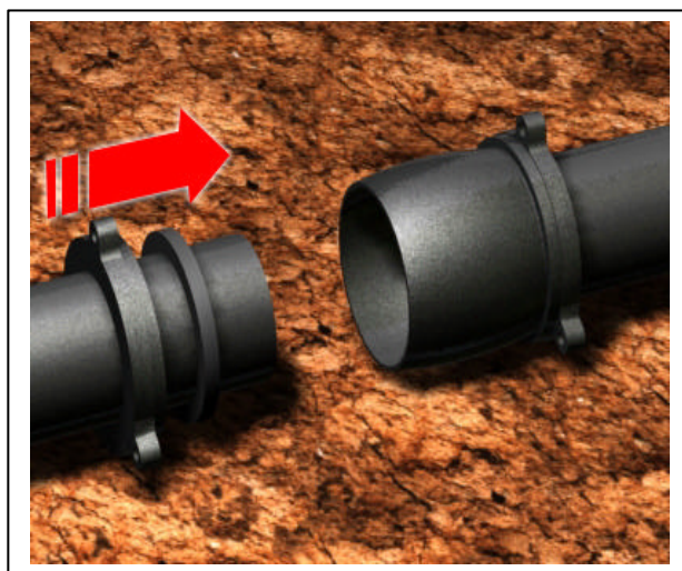
Fig 03. Os tubos deverão ser aproximados e a luva deslocada...
