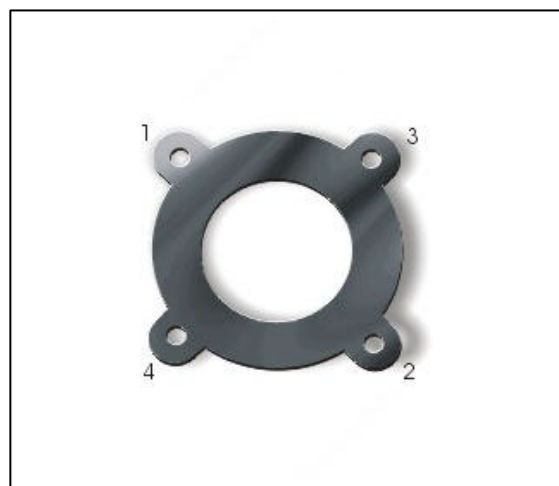
Fig 06. O aperto dos tirantes deverá ser feito de forma alternada, até a obtenção de uma compressão adequada do anel de vedação.
