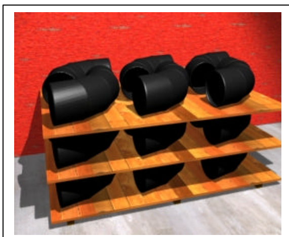
Fig. 04. Armazenagem de conexões em aço
