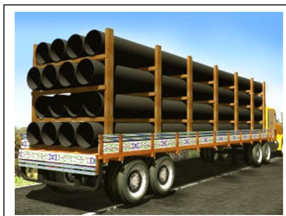
Fig. 01. Transporte de tubos com confinamento lateral.
