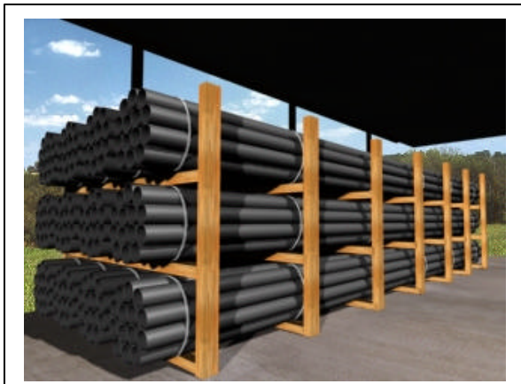
Fig. 04. Estocagem de feixes de barras de tubos
