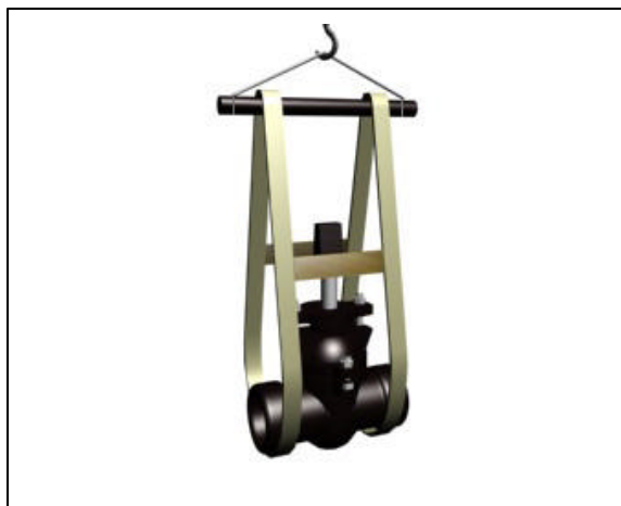
Fig. 01. Movimentação com utilização de cintas e "balancim"
