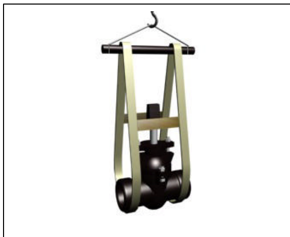
Fig. 01. Movimentação com utilização de cintas e "balancim"
