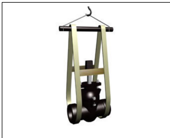
Fig. 01. Movimentação com utilização de cintas e "balancim"
