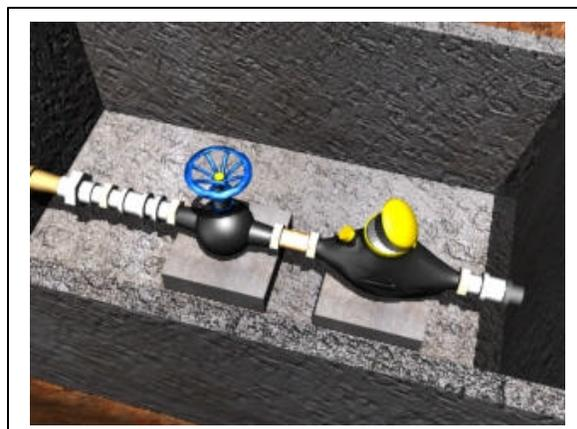
**Fig. 01b.** Caixa de hidrômetro de chafariz padrão com três torneiras
