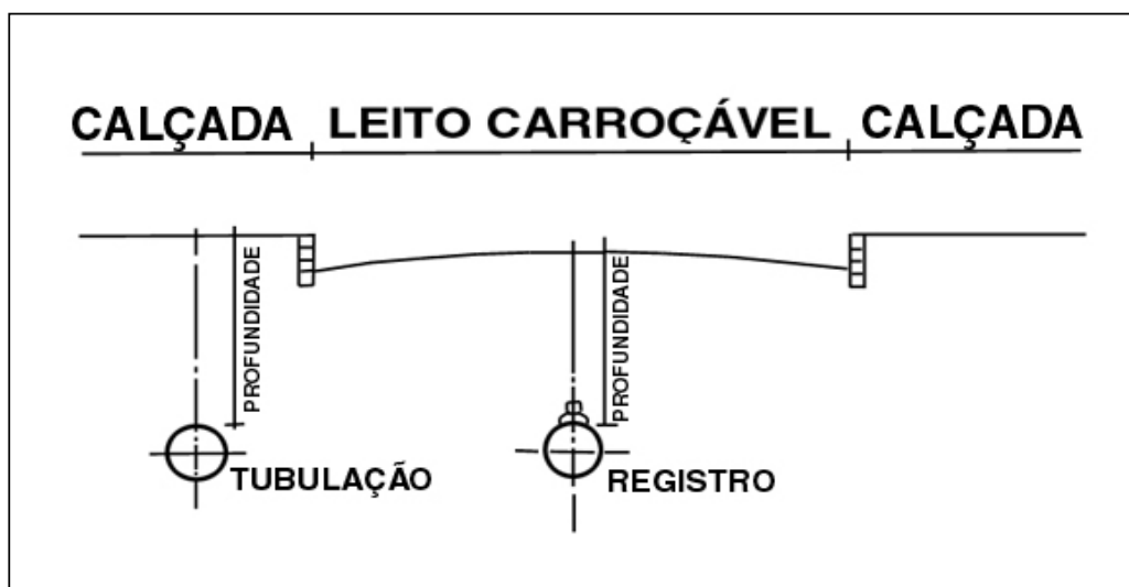
Fig. 16. Determinação da profundidade da tubulação ou peça
