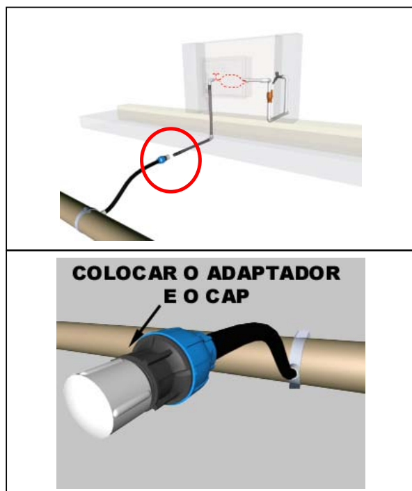
Figura 06. Representação esquemática de “Corte em grande consumidor” em hidrômetros de 10,0m3 a 20,0m3
